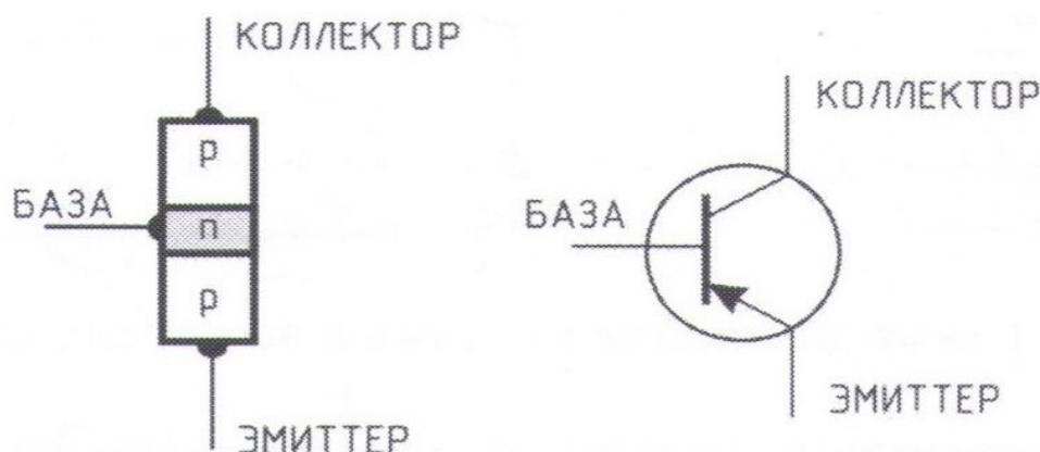
Рисунок 2.2 Устройство p-n-p транзистора и его условное обозначение
