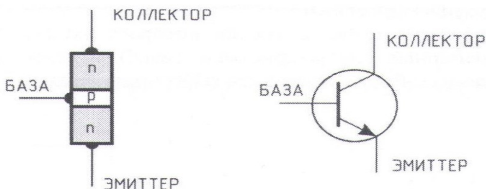
Рисунок 2.1. Устройство n-p-n транзистора и его условное обозначение
